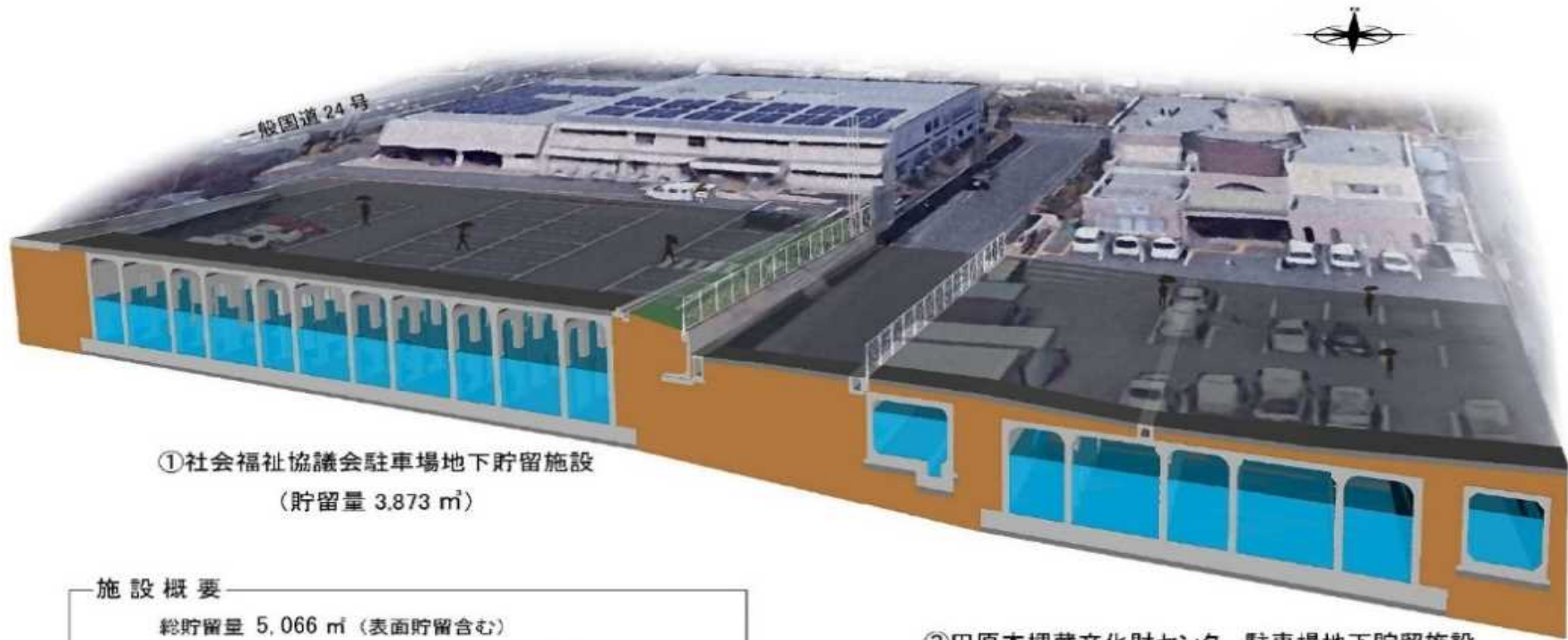
②田原本埋蔵文化財センター駐車場地地下貯留施設 (貯留量 1,127 m 3 )
